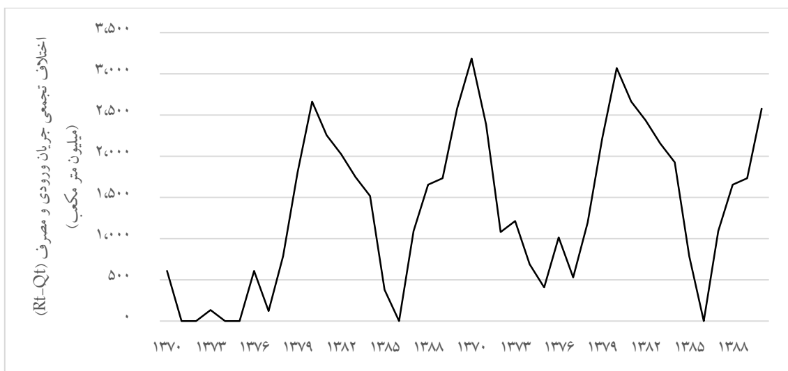
شکل ۵-۳۵- مقادیر مثبت حجم تجمعی کمبودها در حوضه آبریز زاینده‌رود به روش دیاگرام توده‌ای
